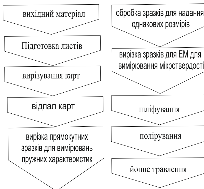
Рис.3.5. Схема обробки зразків для електронно-мікроскопічних досліджень структури, текстури на мікро та мезорівнях.
